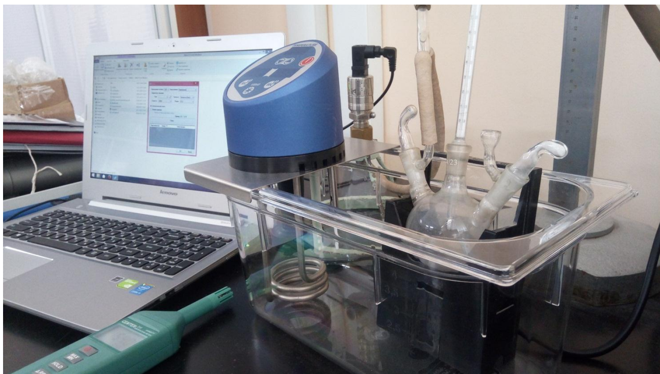
Рисунок 2.6 - Внешний вид эталона для области измерений давления насыщенных паров жидкости
