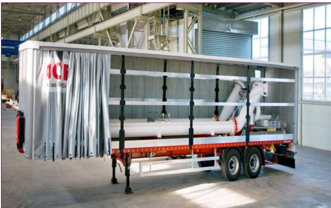
Рис. 1.6 Трубопоршневая двунаправленная поворачивающая установка производительностью 650м 3 /ч (конфигурация "Скорпион"), ООО «СНГБ» г. Калининград
