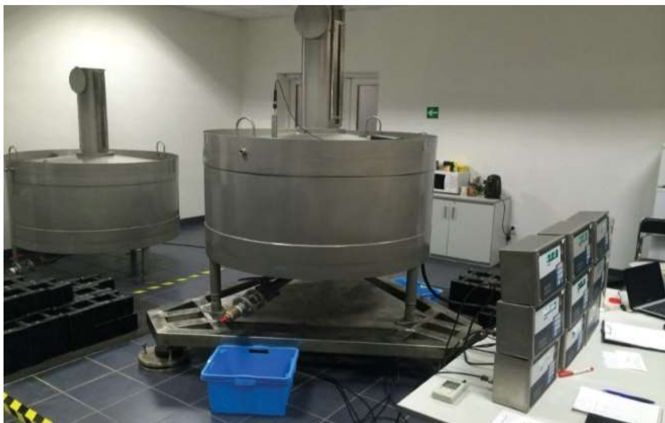
Рис. 2.2 Определение вместимости мерника на весах ВСПМ-1500
