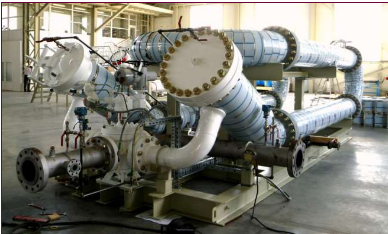
Рис. 1.6 Трубопоршневая двунаправленная поворачивающая установка производительностью 650м 3 /ч (конфигурация "Скорпион"), ООО «СНГБ» г. Калининград
