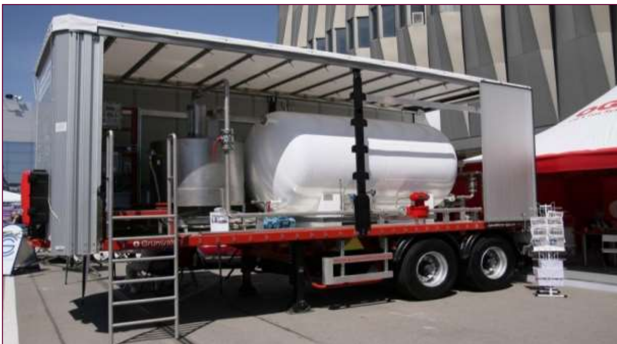
Рис. 1.2 Мобильная эталонная установка ООО «СНГБ» на базе мерника и объемного счетчика
