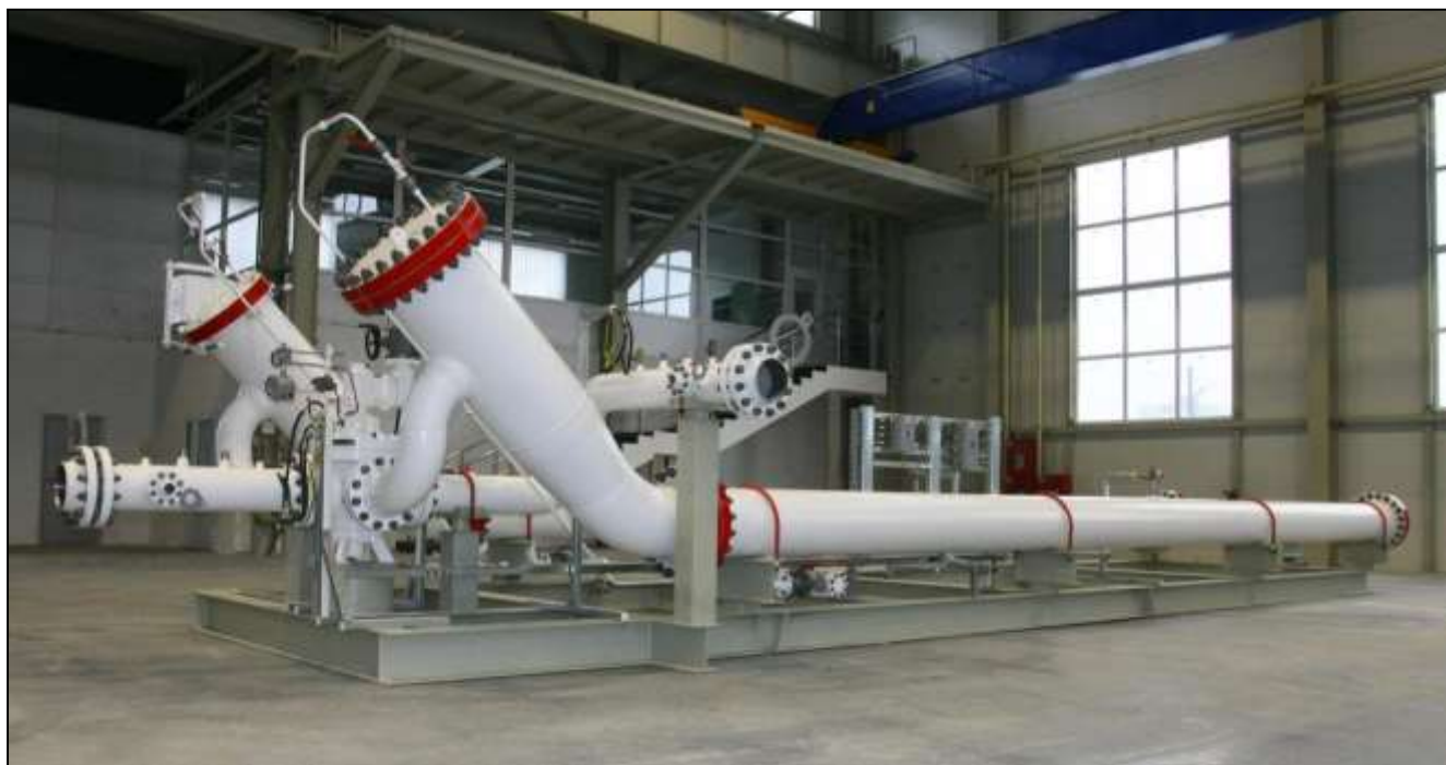
Рис. 1.4 Трубопоршневая двунаправленная поверочная установка, производительность 550\text{м}^3/\text{ч} , ООО «СНГБ» г. Калининград
