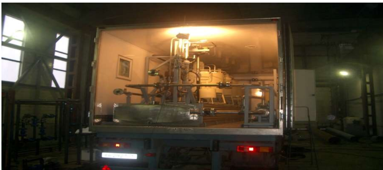
Рис. 1.1 Поверочная установка на базе эталонных мерников
