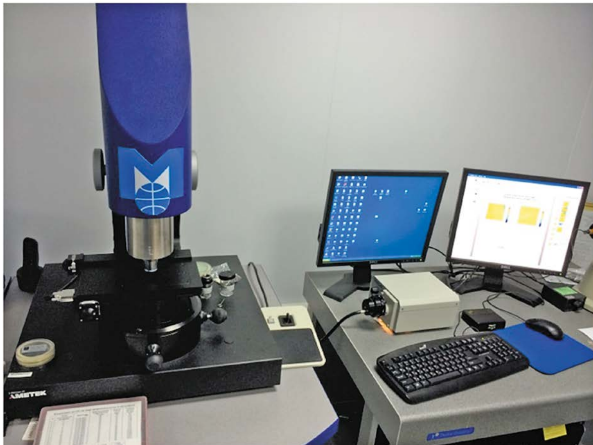
Рис. 5. Профилометр Talysurf CCI 6000 со скомпенсированными систематическими погрешностями нелинейности пьезопозиционера погрешностями неравномерности ПЗС матрицы
