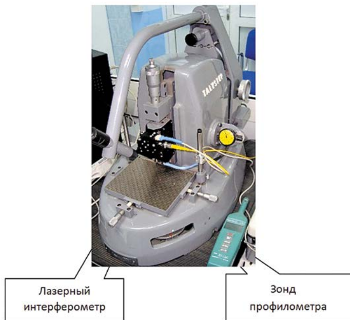
Рис. 1. Модернизированный прибор Talystep с лазерным интерферометром Майкельсона и контактным зондом профилометра
