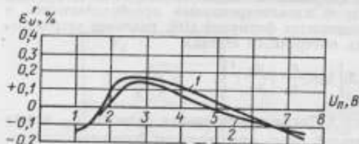
Рис. 6. Кривые погрешностей преобразователя, полученные при непосредственной проверке (1) и по данным определения характеристик (2)
