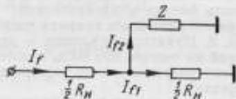
Рис. 5. Эквивалентная схема цепи термопреобразователя
