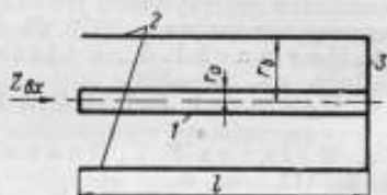
Рис. 2. Коаксиальный резистор в виде короткозамкнутой линии передачи
