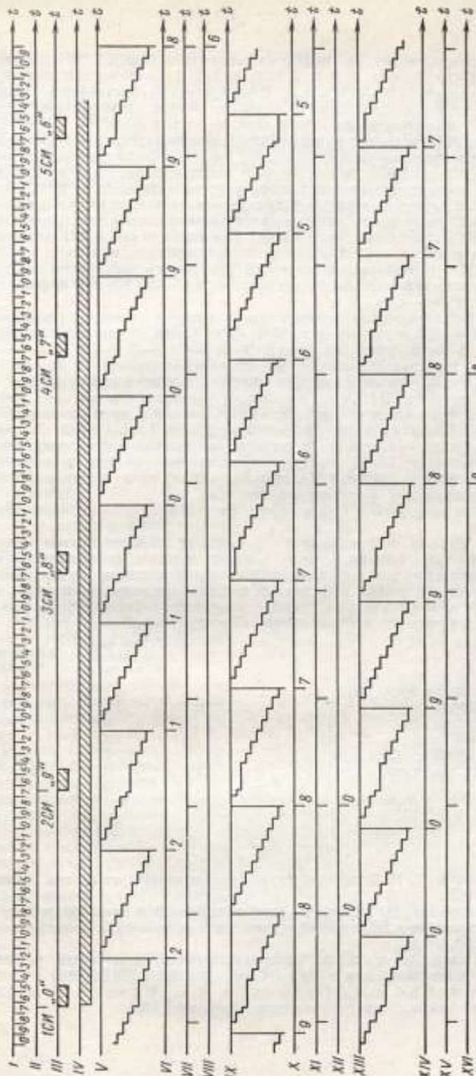
Рис. 5. Временная диаграмма работы устройства в режиме вывода информации об отрицательном входном сигнале.
