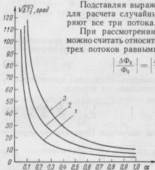
Рис. 2. Погрешность \sqrt{\frac{\Delta T_2^2}{T_2^2}} при \beta = 2 для температуры T_2 , равной: 3000° К (1), 4000° К (2) и 5000° К (3).
