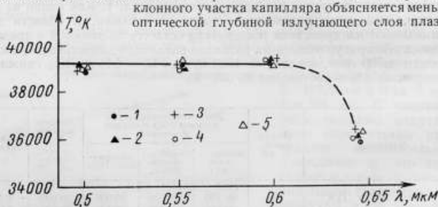
Рис. 15. Зависимость яркостной температуры источника ЭВ-45 от длины волны для разрядов в пластинах из текстолита при длительности разряда \sim 150 (1), \sim 300 (2), \sim 450 мксек (3) и в пластинах из полиметилметакрилата: \sim 150 (4) и \sim 300 мксек (5).
