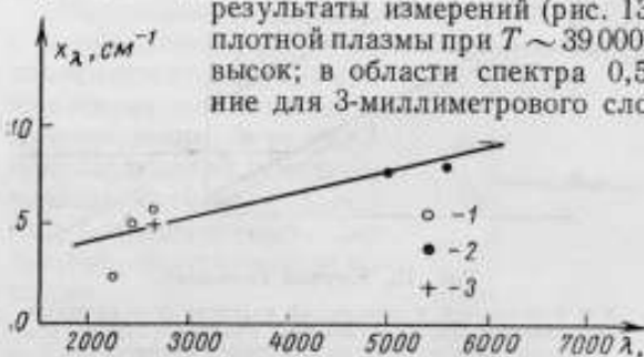
Рис. 14. Зависимость коэффициента непрерывного поглощения плазмы от длины волны \lambda при T \approx 39000^\circ \text{ К} и давлении P \approx 500 \text{ ат} .
