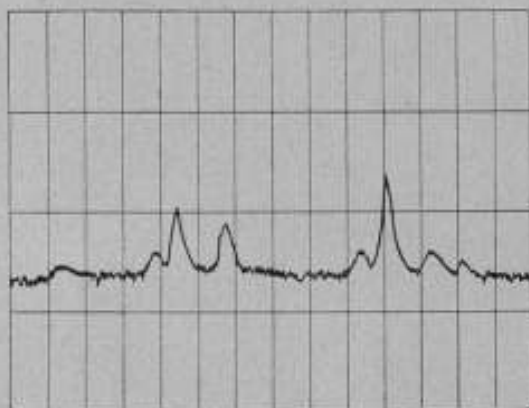
Рис. 9. Запись контура излучения лазера.
