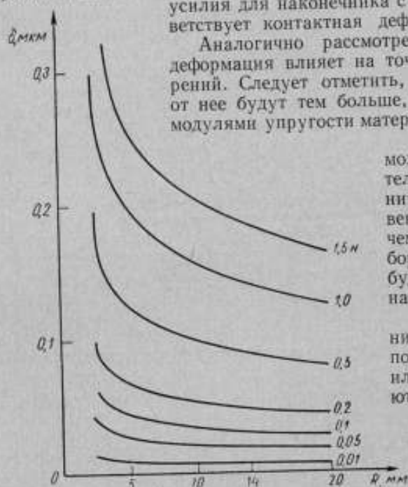
Рис. 1. Зависимость контактных деформаций от радиуса сферы измерительного наконечника для стальной детали.
