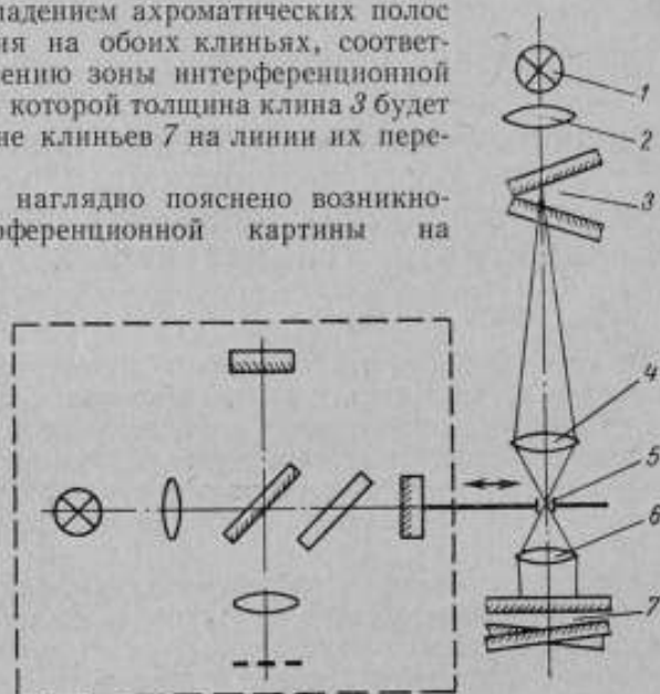
Рис. 1. Оптическая схема установки для фиксации положения прозрачного штриха с интерферометром Майкельсона.
