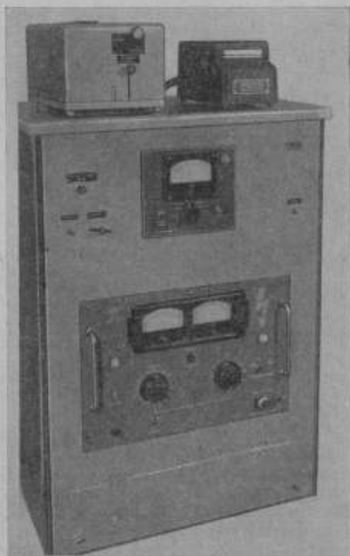
Рис. 2. Внешний вид блока фотоэлектрической регистрации.
