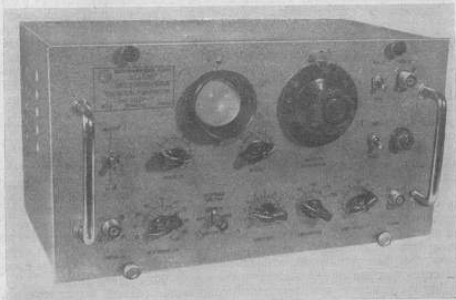
Рис. 1. Электронно-лучевой указатель равновесия ЭЛУР-7.
