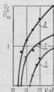
Рис. 4. Зависимость амплитуды генерации от напряжения на сортирующей системе при разных интенсивностях пучка для молекулярного генератора на левом пучке:
