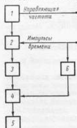
Рис. 1. Блок-схема электронного суммирующего хронографа.
