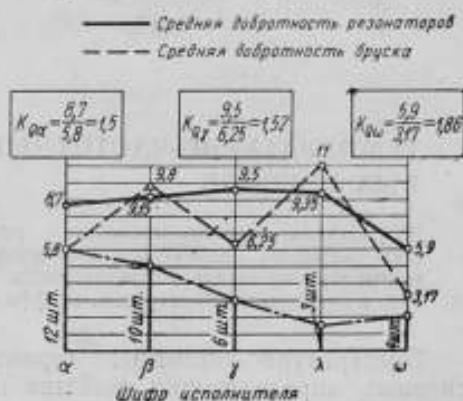
Рис. 13. Корреляция между производительностью исполнителя, средней добротностью брусков и средней добротностью резонаторов за 1960 год.
