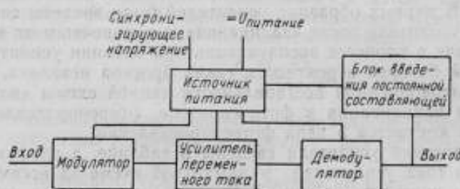
Рис. 3. Блок-схема усилителя постоянного тока с промежуточным преобразованием постоянного тока в переменный.
