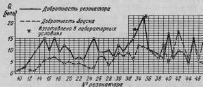
Рис. 12. Корреляция между добротностью брусков и резонаторов в мелкосерийном производстве за год.
