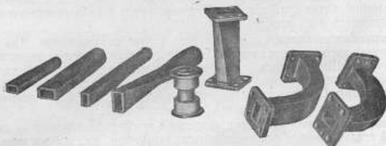
Рис. 10. Детали волноводов, изготовленные из меди по вытравляемым алюминиевым формам
