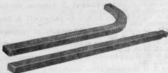
Рис. 13. Никелевый волновод с отверстиями связи
