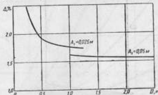
Рис. 5. Погрешность, вызванная неточностью измерения величин, входящих в расчетные формулы для E
