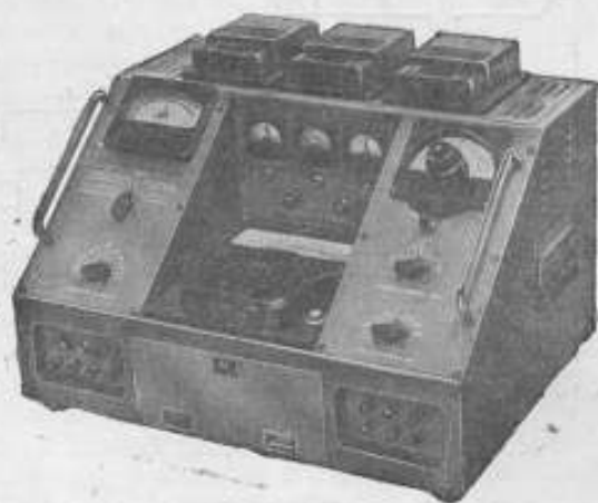
Рис. 2. Внешний вид образцового термисторного моста МТО-1
