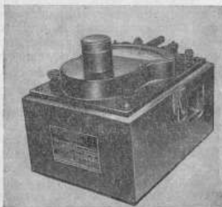
Рис. 1. Экранированный электродинамический малокосинусный ваттметр, изготовленный заводом «Эталон».
