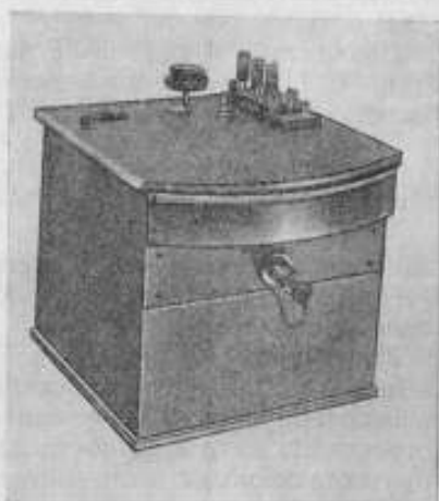
Рис. 1. Высокочувствительный ваттметр для измерений при повышенных частотах и малых значениях коэффициента мощности.
