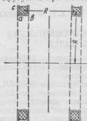
Рис. 1. Разрез образцовой катушки напряженности поля:
