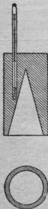
Рис. 9. „Тело комнатной температуры“ — алюминиевый цилиндр с конической полостью.
