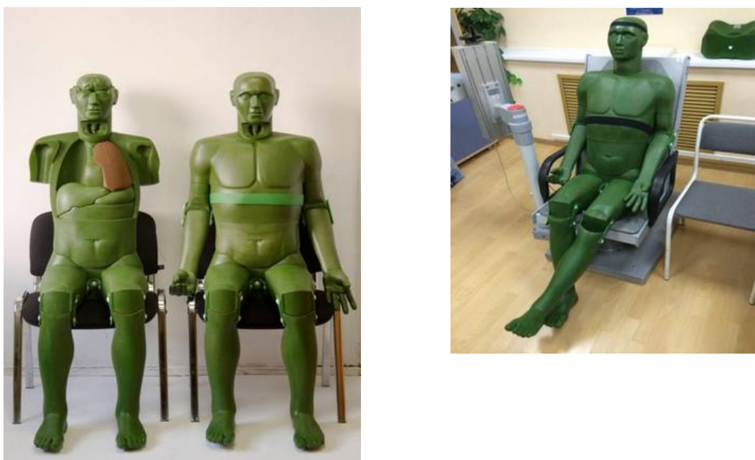
Рисунок 1 – Фантом тела и органов человека в измерительном положении на Измерительном СИЧ АЭС, измерение ^{60}\text{Co} в лёгких
